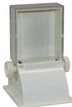
Aus PP für 72 Objektträger. Durch Drehen des Knopfes wird jeweils 1 Objektträger herausgegeben. Nur trockene Objektträger einfüllen. Transparentes Oberteil kann zur Befüllung abgenommen werden. Für Objektträger mit Abmessungen 75 x 25 mm und 76 x 26 mm.
