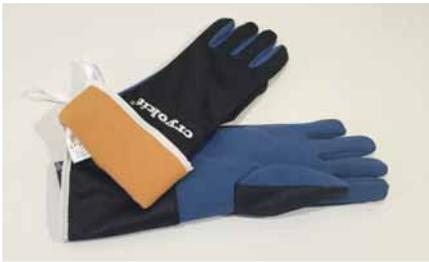
Einsetzbar für alle Arbeiten mit flüssigem Stickstoff und anderen kryogenen Gasen bis ca. minus 196 °C. Schützt vor Kältekontakt und Verbrennungen im Fall des Austretens von tiefkalten Medien. Innere Isolierung: Polyester Mehrschicht-Vlies (410 g/m<sup>2</sup>) und Polyolefin-Porelle-Membrane. Gemäss EN 511, EN 420, EN 388, **Kat.III**. Achtung: Nicht geeignet zum Eintauchen in tiefkalte Flüssigkeiten. Packung à 1 Paar.
