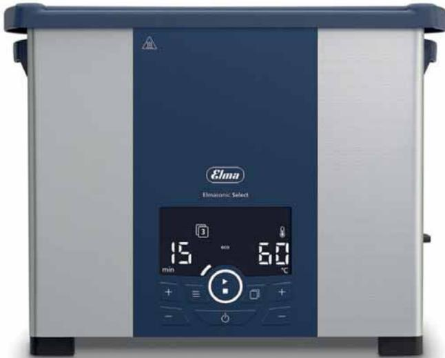
Vielseitig einsetzbare Ultraschallbäder mit einer Ultraschallfrequenz von 37 kHz, 5 Ultraschallmodi (dynamic, pulse, sweep, degas, eco), Heizung und der Möglichkeit bis zu 4 individuelle Reinigungsprogramme zu speichern.
