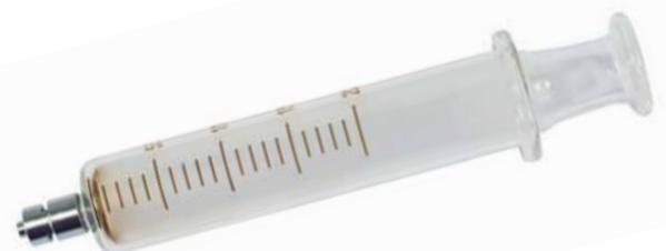
Mit brauner Graduierung. Sterilisierbar bis 134 °C. Material Konus: Metall, Ansatz: Luer-Lock.
