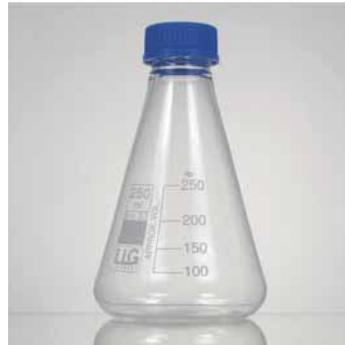
Erlenmeyerkolben aus Borosilikatglas 3.3, Schraubverschluss mit PTFE- Dichtungseinlage.
