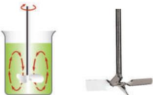
Der 4-flügelige Schrägblattrührer sorgt für ein axiales Strömungsbild und es entstehen bei höheren Drehzahlen zunehmend Scherkräfte an den Rührblättern.
