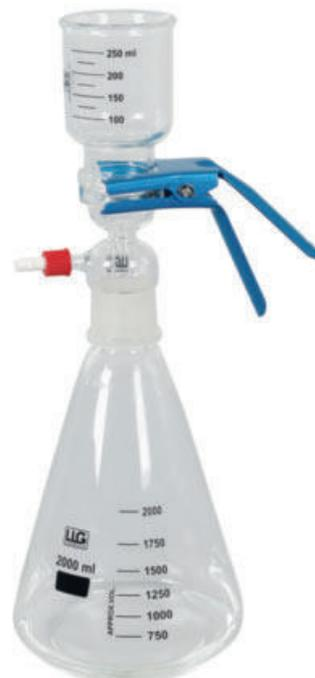
Universell einsetzbare Filtrationseinheit aus hochwertigem Borosilikatglas. Breites Anwendungsspektrum für die Filtration mit Filterpapier oder Membranfiltern (47 mm).
