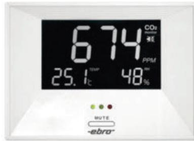
Zur verlässlichen Kontrolle und Beurteilung der Raumluftqualität. Gleichzeitige Messung und Anzeige von Temperatur, CO<sub>2</sub>-Gehalt und Feuchte. Der CO<sub>2</sub>-Gehalt der Luft wird zusätzlich anhand dreier LEDs als gut, mittel oder schlecht angezeigt.
